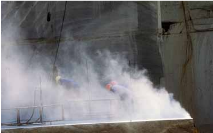
Bušenje primarnog bloka ručnim bušaćim čekićem uz obvezno korištenje zaštitne opreme (respiratori) zbog opasne silikatne
