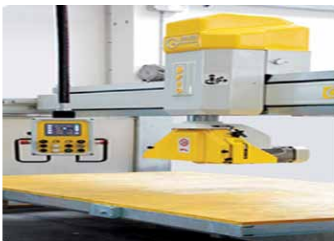
Mosni stroj (freza) sa okretnim stolom za rezanje granitnih ploča
