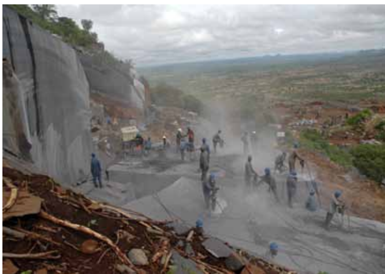
Ručno bušenje primarnog bloka, za cijepanje klinovima, pomoću bušaćeg čekića
