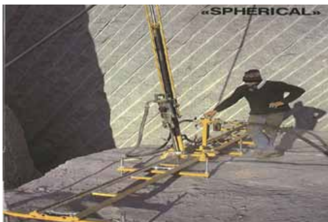
Lafetna bušilica s jednim hidrauličko potiskivanim bušačem čekićem, gibanje tornja po nazubljenoj letvi
