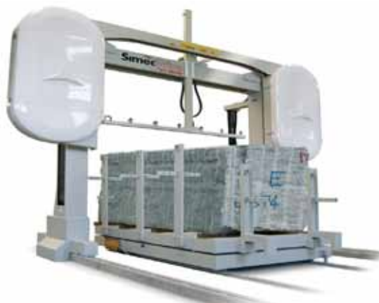
Stroj za rezanje granita s jednim elastičnim radnim organom
