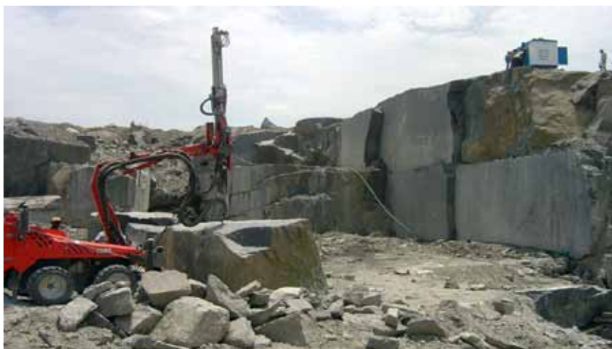
Samohodna bušača garnitura za bušenje granitnih blokova
