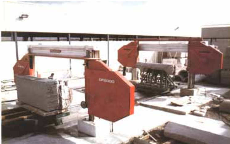
Slika 3.21. Dijamantni žični gater za oblikovanje granitnih blokova
