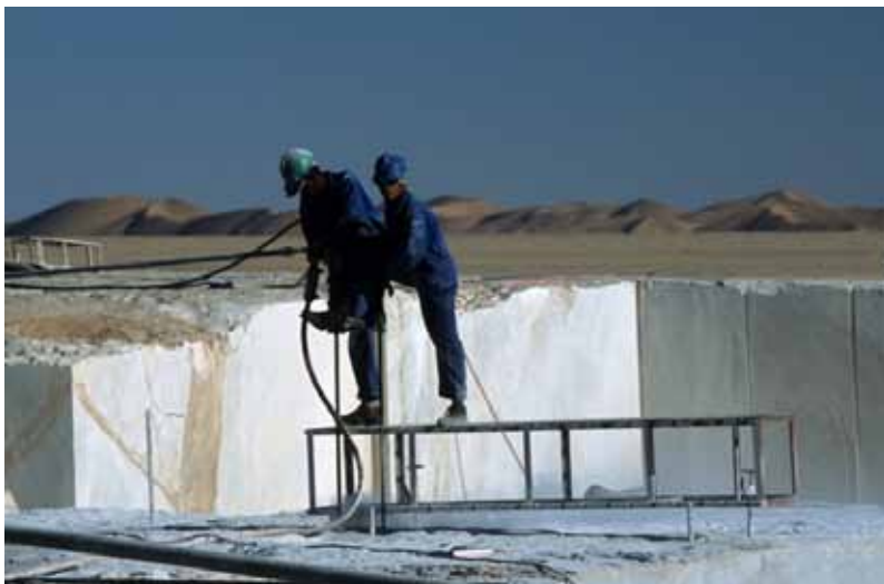
Bušenje primarnog bloka koristeći rampu kojom se pomoću užljebljenja ostvaruje pravac i paralelnost bušotina
