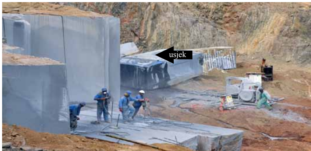
Usjek otvoren kombinacijom miniranja i dijamantne žične pile
